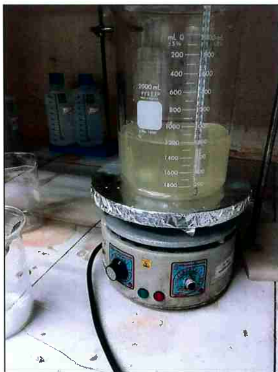
Figura 27 - Resina de MgO sendo preparada pelo método de Pechini.
