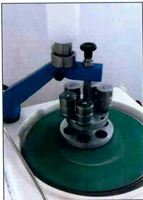
Figura 35 - Polimento de amostras em politriz automática.
