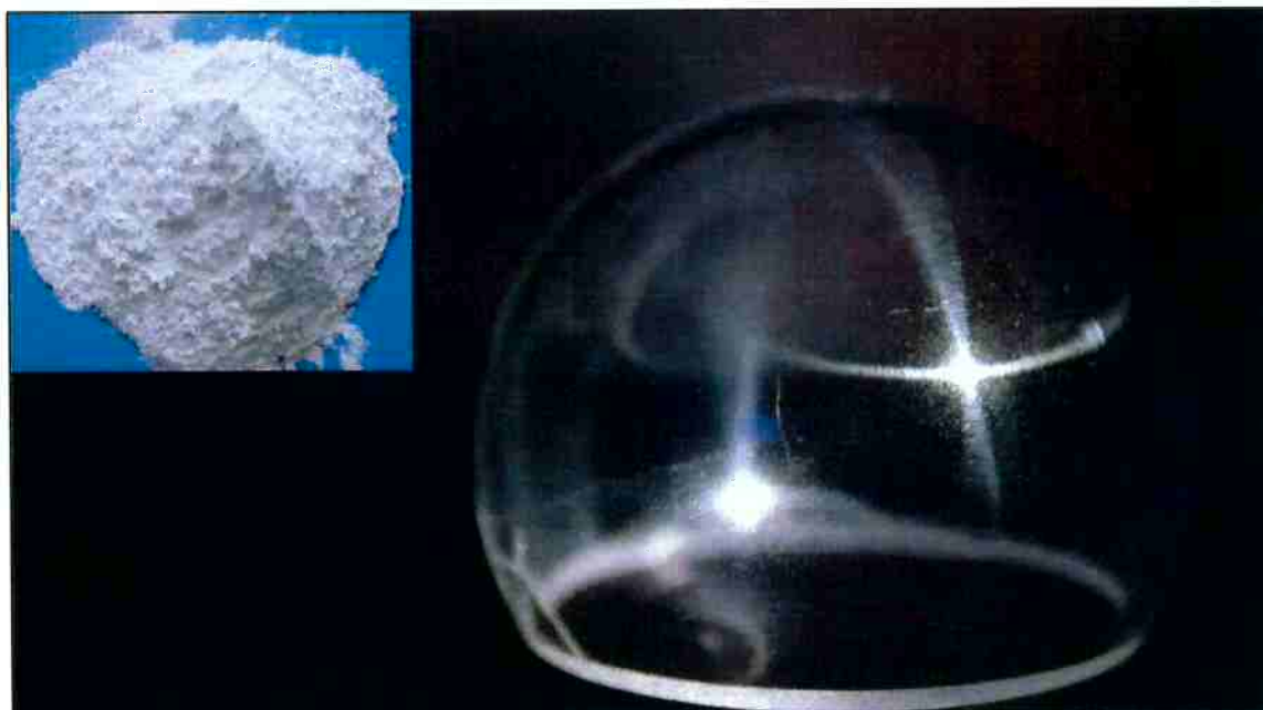
Figura 19 - Aluminato de magnésio puro na forma de pó e peça de aluminato de magnésio após tratamento térmico e acabamento (Fonte: US Naval Research Laboratory, adaptado).
